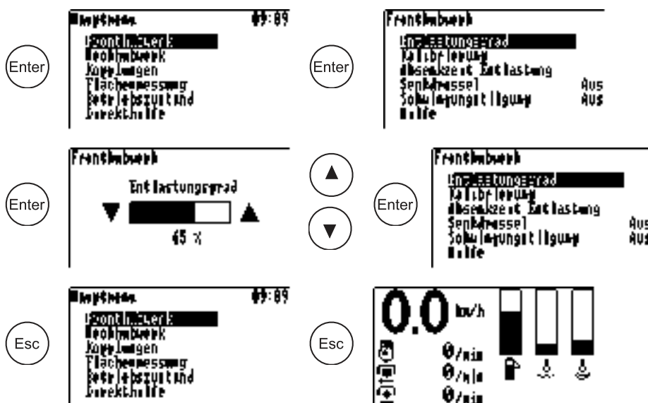
Abb. 52 Beispiel: Einstellung der Entlastung Fronthubwerk
