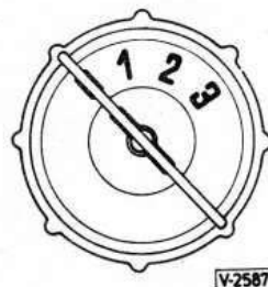
3-4. ábra. Központi világításkapcsoló /V-2587/
