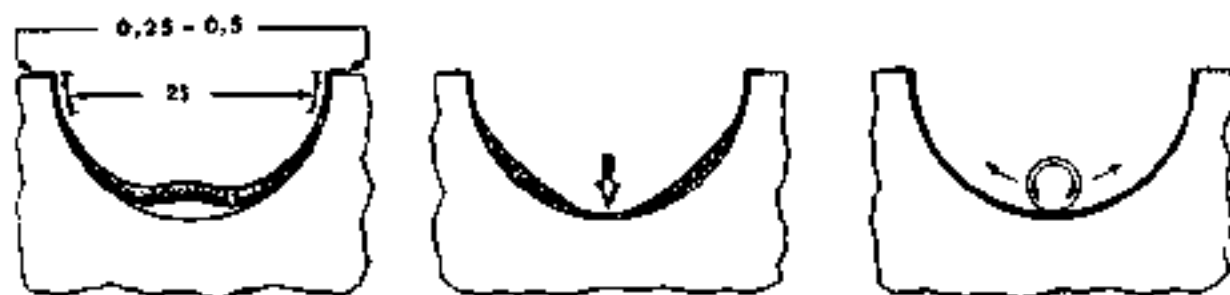
Sl. 28.36 — Postavljanje uljne zaptivke radilice
