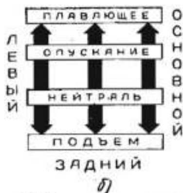
Рис. 3. Положение органов управления во время переключения передач (а), переключения рычагов гидросистемы (б) и положение рычагов запуска пускового двигателя (в)
