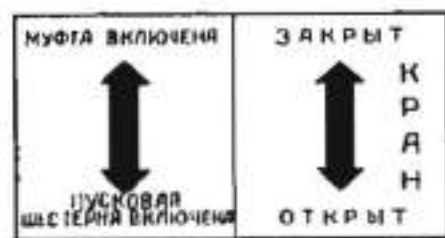
Рис. 3. Положение органов управления во время переключения передач (а), переключения рычагов гидросистемы (б) и положение рычагов запуска пускового двигателя (в)
