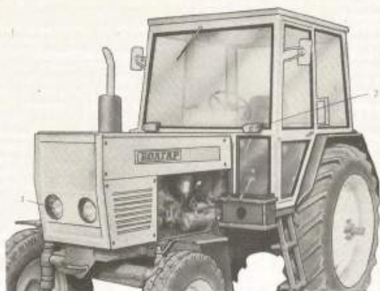
Фиг. 76. Разположение на предните фарове:
