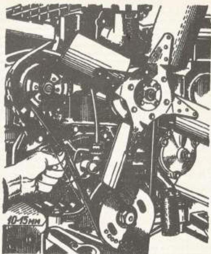
Фиг. 24. Проверка натягането ремъка на вентилатора
