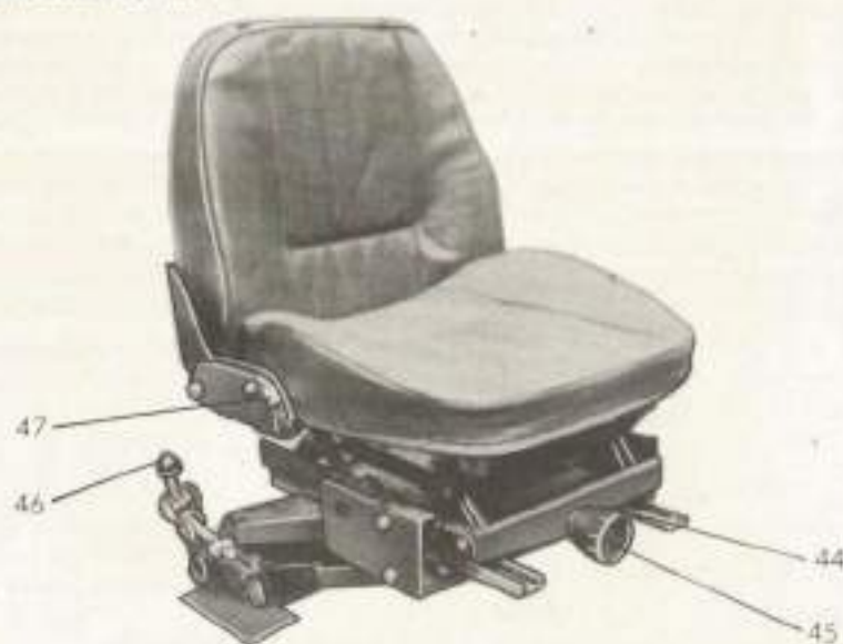
Фиг. 7. Органи за регулиране на седалката 44 — лост-фингалер; 45 — ръкохватка; 46 — винт; 47 — косоур.
