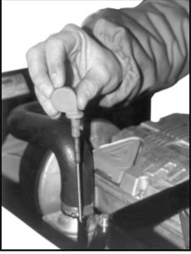
Si le témoin du niveau de l'huile s'allume (10) cela signifie que la lubrification du moteur est insuffisante. Dans ce cas arrêter immédiatement le moteur, attendre quelques minutes et donc vérifier le niveau de l'huile par l'intermédiaire de la tige correspondante. Dans le cas où le niveau est insuffisant remplir par le bouchon ouvert d'une huile appropriée jusqu'à ce que le niveau revienne entre les signaux marqués sur la tige de niveau.
