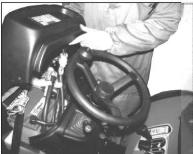
Si le tracteur a des problèmes à l'allumage, il est conseillé de vérifier l'état de la batterie. Enlever la partie supérieure du tableau de bord (fig.5.19). Pour dégager la batterie il est nécessaire d'enlever la borne des plaques. Enlever donc la batterie. Vérifier le niveau de l'électrolyte et si besoin est ajouter de l'eau distillée jusqu'à ce que le niveau dépasse la hauteur des plaques internes.
