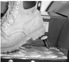
La petite pédale de blocage du différentiel se trouve à hauteur du talon gauche du conducteur. Quand une roue de traction dérape et le tracteur reste bloqué, il faut appuyer avec le talon gauche sur la petite pédale de blocage du différentiel. Après une fraction de tour de la roue qui dérape, la roue bloquée entrera en synchronisation avec celle-ci pour permettre au tracteur de se libérer.
