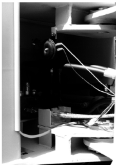
Fig. 5-3 Posiciones de lubricación de articulación central (superior e inferior)
