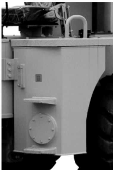
Fig. 5-8 Posición de depósito hidráulico
