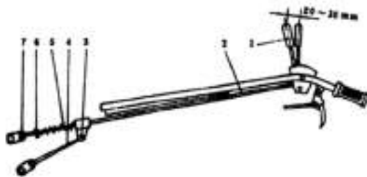
Рис. 9. Регулировка системы управления тормозом/сцеплением
