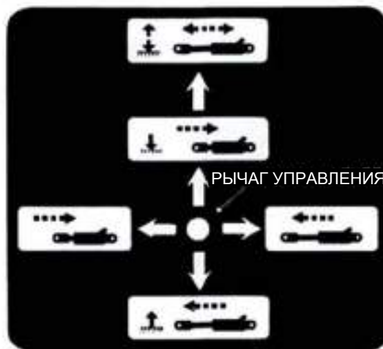
Рис. 42. Работа двухкаскадного клапана управления
