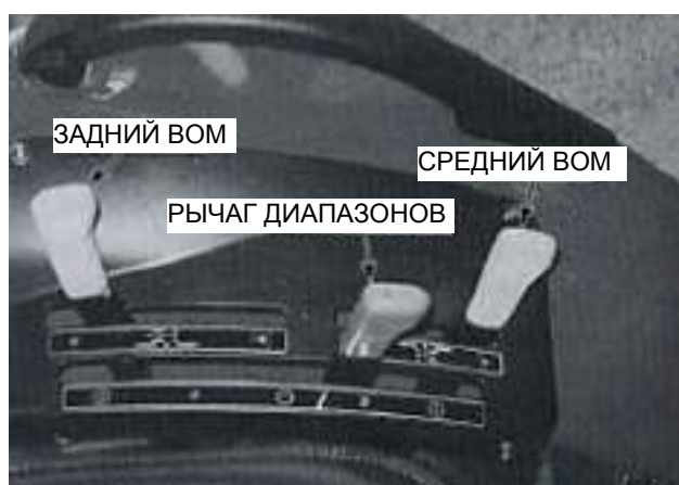
Рис. 10. Задний ВОМ, средний ВОМ и рычаг диапазонов.
