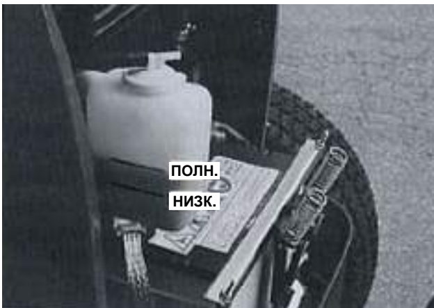
Рис. 59. Резервуар с охлаждающей жидкостью
