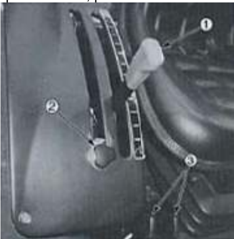
Рис. 34. Система управления гидравлическим подъемником
