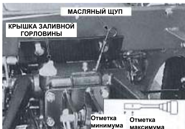
Рис. 55. Заливная горловина и щуп проверки уровня масла в трансмиссии/задней оси и гидравлической системе.
