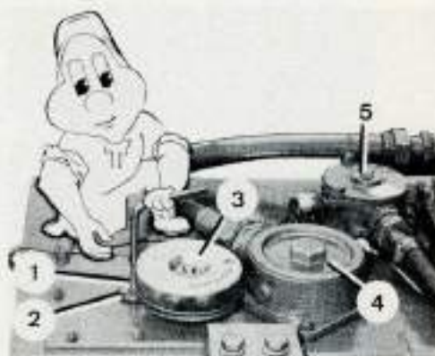
Emplacement de la vanne de fermeture sur le réservoir du circuit hydraulique.
