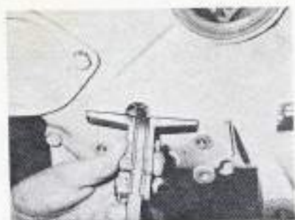
Mesure de l'extrémité avant de l'arbre à cames et la face avant du carter (ancien montage).
