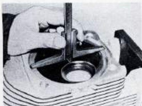
Contrôle de la hauteur de culasse (profondeur de la culasse) le joint de culasse doit être mis en place pour relever la cote.
