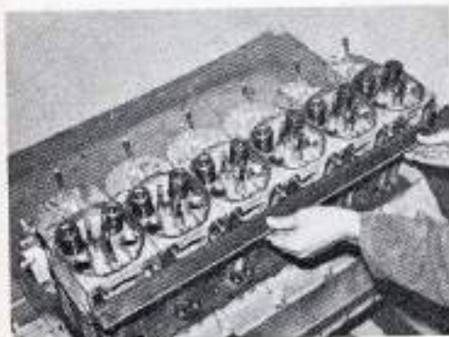
Alignement des culasses sur le moteur F6L912.
