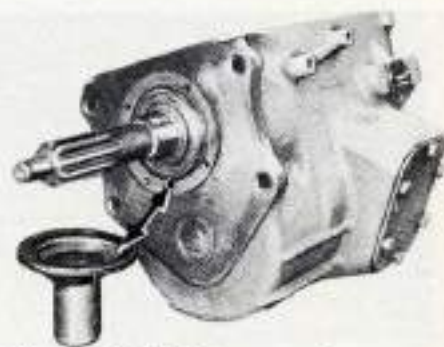
Position du guide de butée par rapport au carter de boîte.
