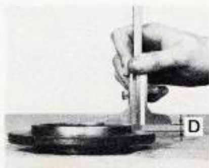
Mesure du couvercle inférieur.
