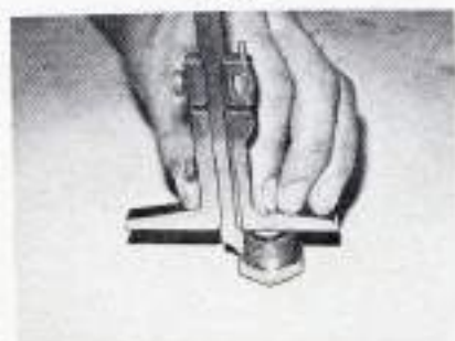
Mesure de la hauteur du bouchon fileté (ancien montage).
