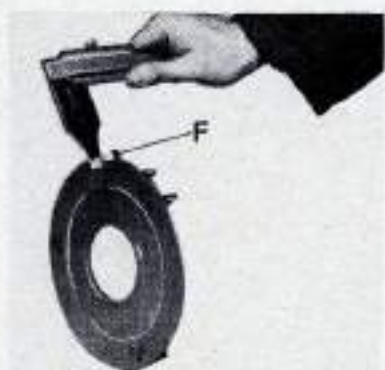
Mesure de l'épaisseur de la turbine à aubes (pas de turbine à aubes sur la pelle 90 P et 115 P).
