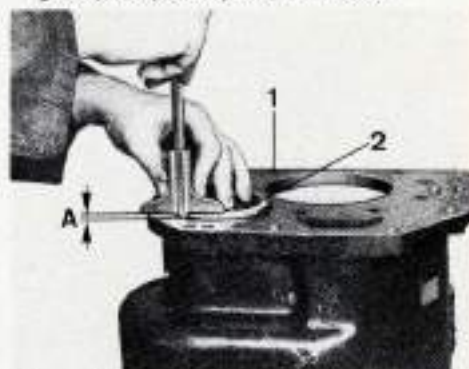
Mesure du dépassement de la cage extérieure du roulement à billes de l'arbre intermédiaire par rapport à la face d'appui du carter de boîte.
