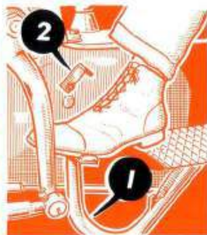
FIG. 5 B. — Pédale de débrayage (1) avec butée (2) libérant la course totale.
