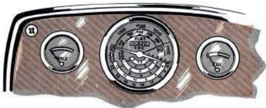
FIG. 22 — Horomètre. Au centre de l'horotachymètre.
