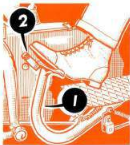
FIG. 5 A. — Pédale de débrayage (1) avec course limitée par la butée (2)
