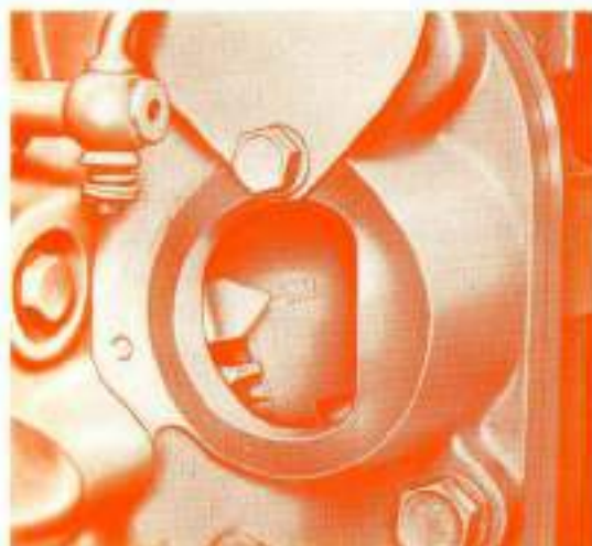
FIG. 35. — Référence sur le volant indiquant l'avance à l'injection (22 + 1° avant le P. M. H.)
