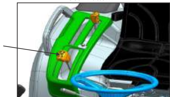
1. Main Gear Shift Lever
