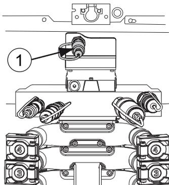
1. Acoplamiento rápido de aire comprimido
