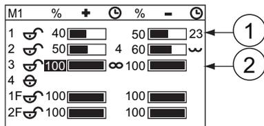
1. La primera válvula trasera se ha programado con un bloqueo de posición de 23 segundos.
