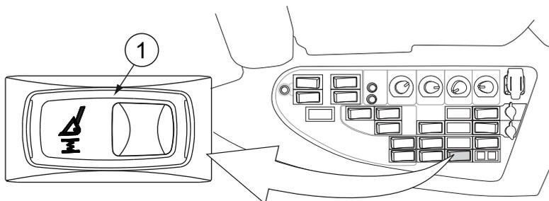
1. Interruptor para el amortiguador eléctrico
