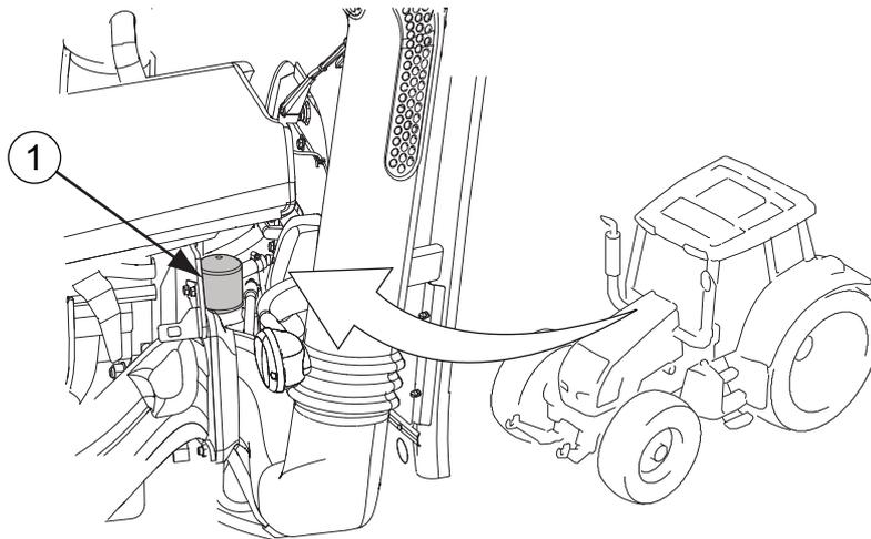
1. Respirador del sistema hidráulico
