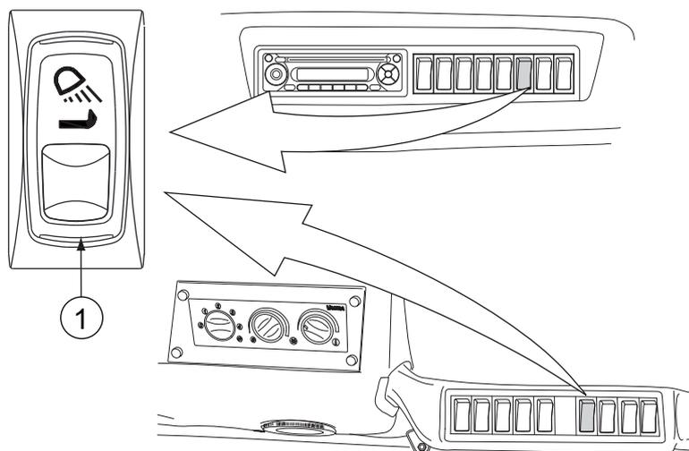
1. Interruptor de la luz del gancho del remolque
