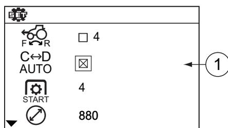
1. Ajuste del sistema de cambio automático de gama de velocidades C-D
