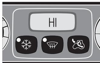
El efecto de calefacción máxima se obtiene ajustando la temperatura de la cabina a más de +28 °C. Cuando el modo HI está activado:
