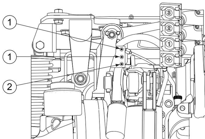
1. Boquillas de purga del cilindro principal de freno del tractor
