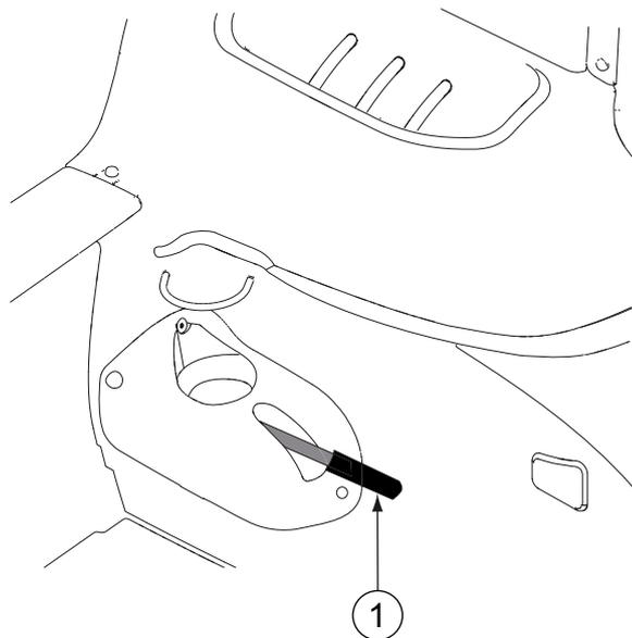
1. Palanca del freno de emergencia
