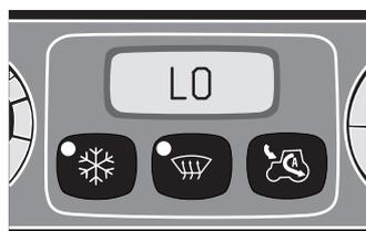
El efecto de enfriamiento máximo se obtiene ajustando la temperatura de la cabina a menos de +18 °C. Cuando el modo LO está activado:
