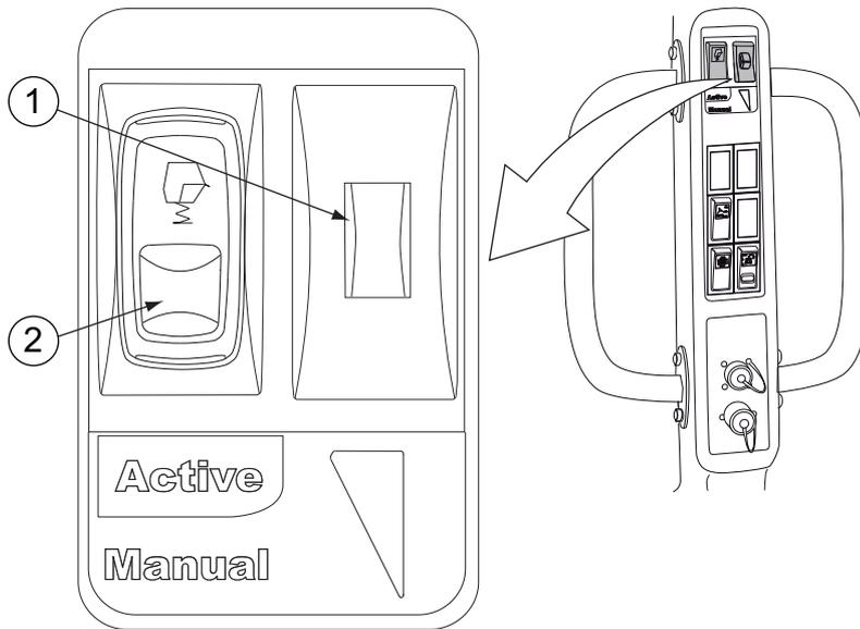
1. Potenciómetro de AutoComfort
