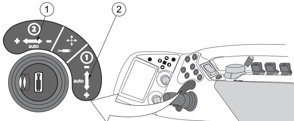
1. Movimiento del joystick para controlar la válvula trasera 2 y la válvula delantera 2F.
