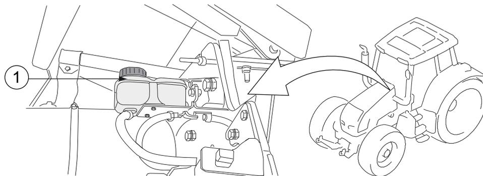
1. Depósito del líquido de frenos
