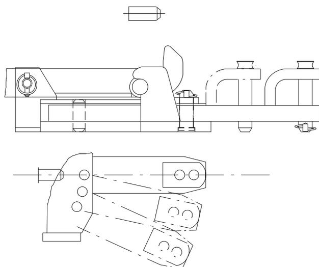
La barra de tiro agrícola se emplea para remolcar implementos cuyo peso está cargado solamente en parte sobre la barra de tiro, por ejemplo, empacadoras. El peso máximo de un implemento con barra de tiro es de 5.000 kg.
