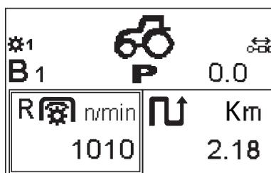
La velocidad de rotación de la TDF se muestra con una precisión de 10 rpm.
