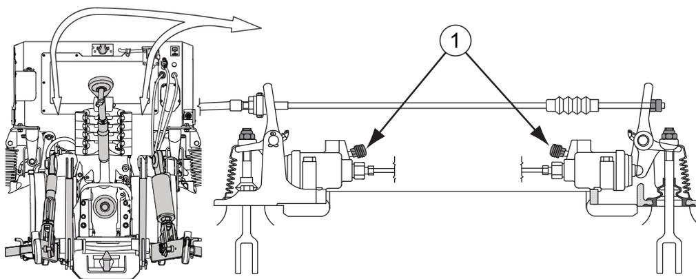
1. Boquillas de purga de los frenos del tractor
