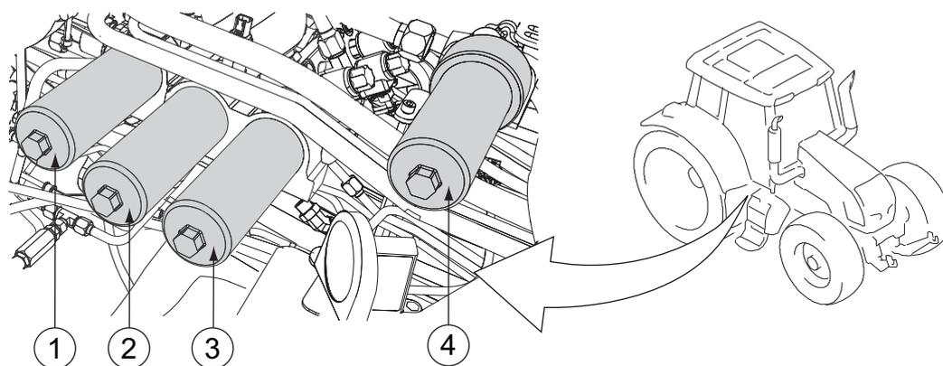
1. Filtro de aceite de retorno del sistema hidráulico auxiliar
