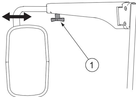
1. Dispositivo de bloqueo del soporte del retrovisor
