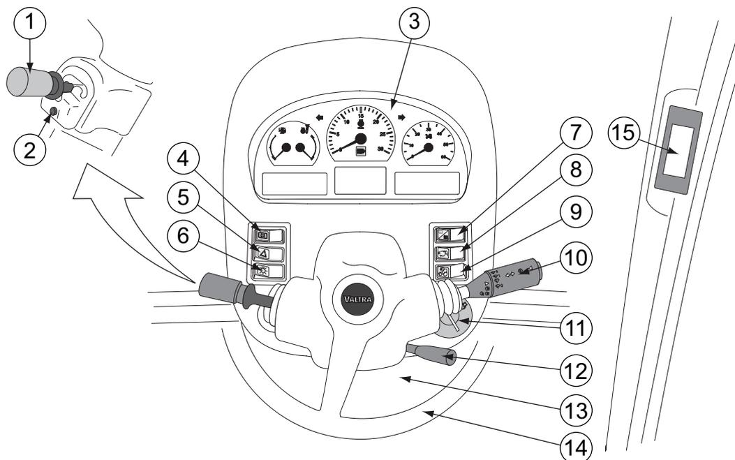
1. Palanca del Power Shuttle
