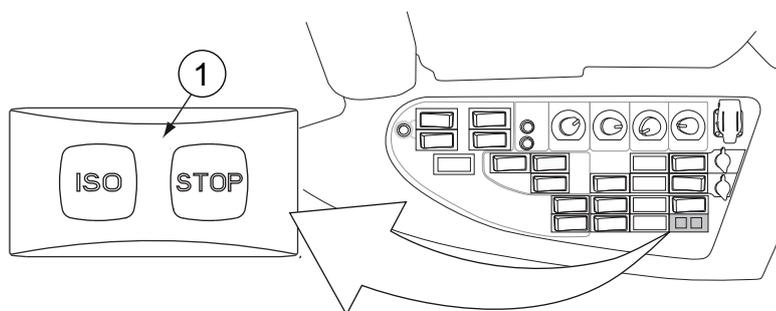
1. Luz indicadora para la conexión de señal del implemento
