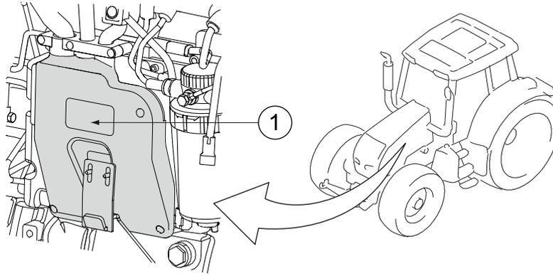
1. Cubierta de la unidad de control del motor
