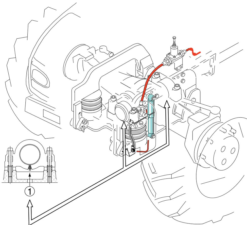
1. Boquillas de engrase de los cojinetes del eje delantero
