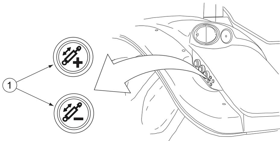
1. Pulsadores (equipo adicional) para la válvula de activación/desactivación trasera 1
