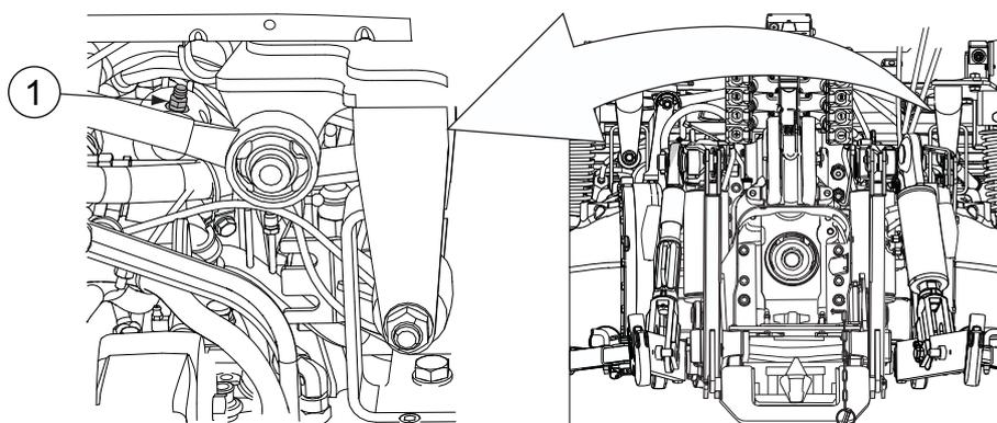
1. Boquilla de purga de la válvula de freno hidráulico del tractor
