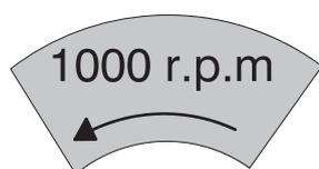
**IMPORTANTE:** La velocidad de rotación nominal del eje de la TDF delantera es de 1.000 rpm y el sentido de rotación es hacia la izquierda visto desde la parte delantera. Compruebe que el implemento es compatible antes de conectarlo.
