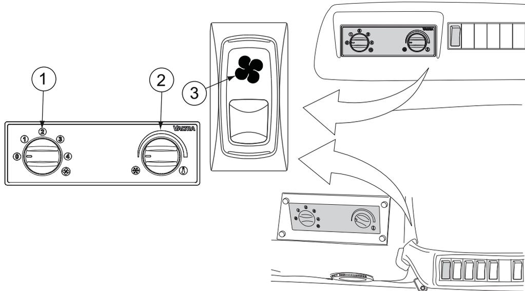
1. Mando del control del ventilador del techo
