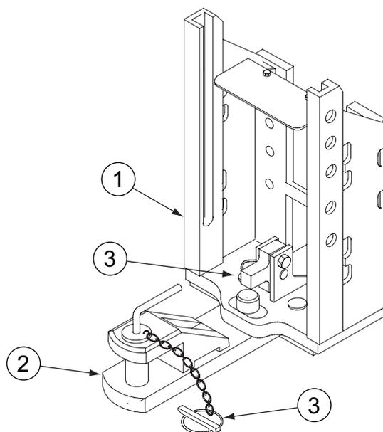
1. Bastidor del dispositivo de enganche con enganche fijo (Piton Fix)
