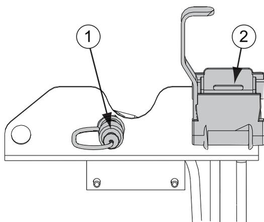
1. Acoplamiento rápido para la salida de aire comprimido
