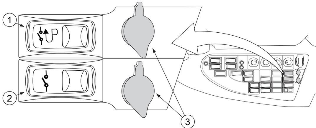
1. Interruptor de potencia, se puede controlar mediante U-Pilot
