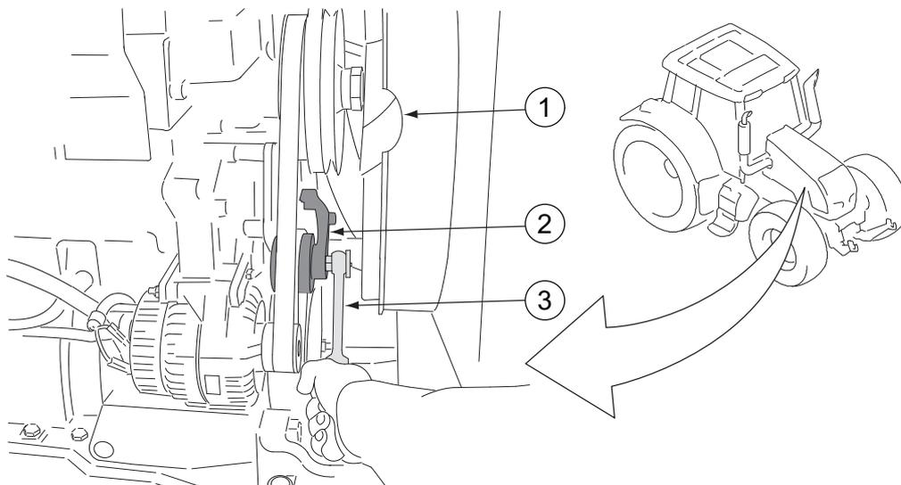
1. Ranura para el cambio de la correa del túnel de viento
