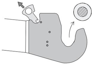
2. Puede dejar el bloqueo abierto tirando de la palanca hacia atrás (por ejemplo, cuando desmonta un implemento).
