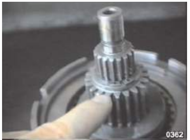
Fig. 22 - Pour la séparation de le Powershift , déposer le circlip représenté sur la figure.
