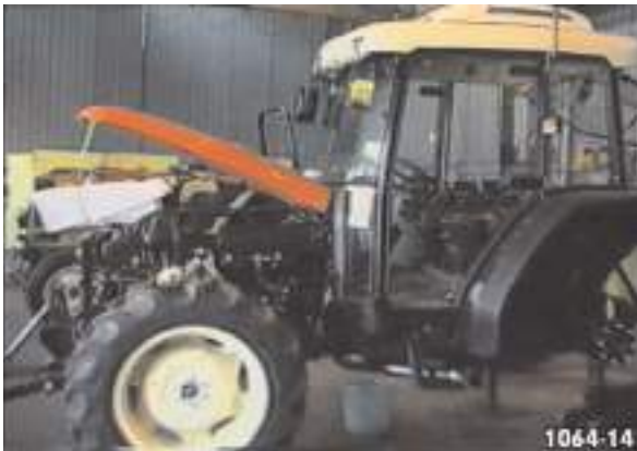
Fig. 15 - Désaccouplement des parties qui unissent la cabine au tracteur.
