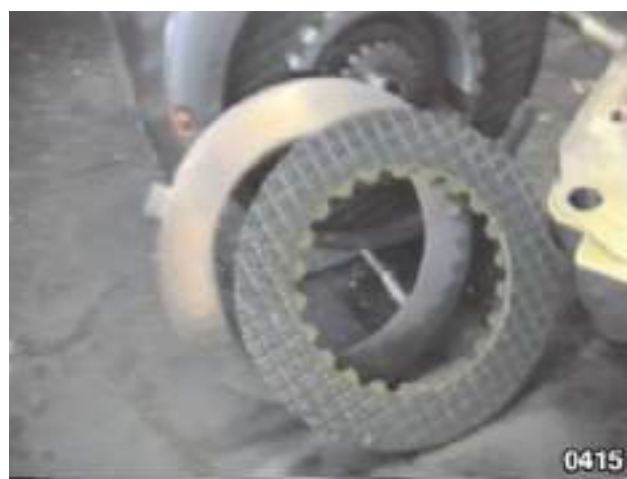
Fig. 30 - Vérifier l'état d'usure des disques de l'embrayage.
