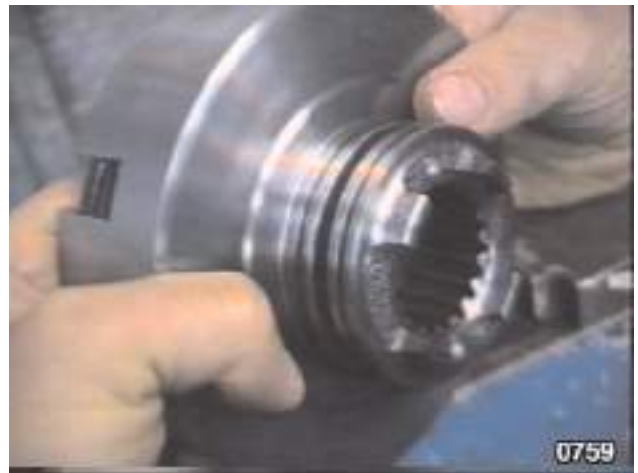
Fig. 56 - Vérifier l'état des segments d'étanchéité "VESPEL" sur la cloche de l'embrayage "HIG".
