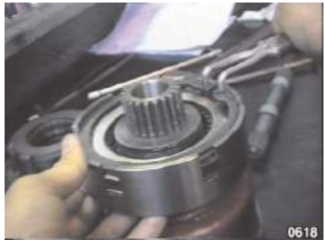
Fig. 46 - Déposer le circlip d'arrêt des disques de l'embrayage "HIGH".
