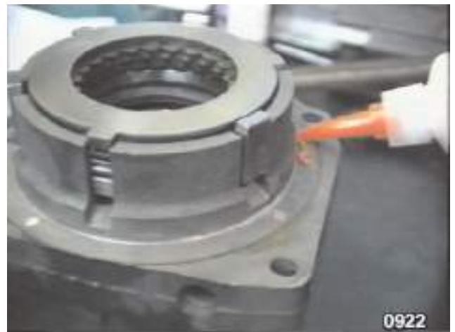
Fig. 75 - Enduire de Loctite 510 la surface de la cloche comme le montre la figure. REMARQUE: lors de l'application de la pâte d'étanchéité prenez soin de ne pas salir les orifices d'alimentation d'huile à l'embrayage.
