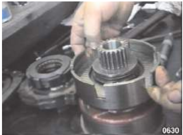
Fig. 48 - Déposer l'empilage des disques de l'embrayage "HIGH" (2 disques d'embrayage + 2 contre-plaques + 1 entretoise).
