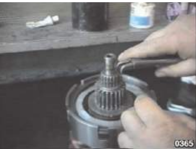
Fig. 23 - Déposer le circlip représenté sur la figure à l'aide d'un pince à circlips.
