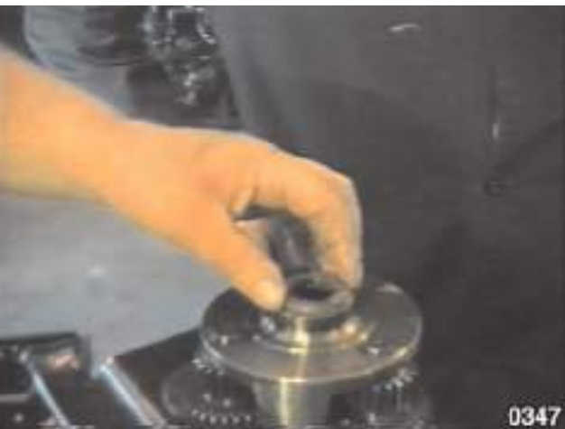
Fig. 21 - La cale de réglage du jeu des arbres de le Powershift est intercalée entre la cloche et le réducteur épicycloïdal.
