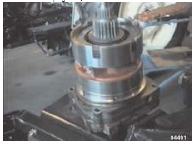
Fig. 59 - Le positionnement de l'ensemble Powershift dans le carter de boîte passe par le réglage du jeu axial de l'arbre en prise avec le réducteur épicycloïdal.
