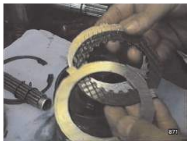
Fig. 42 - Extraire les deux disques d'appui avec le disque de frein.
