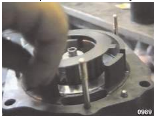
Fig. 82 - Positionner les disques de l'embrayage "LOW".
