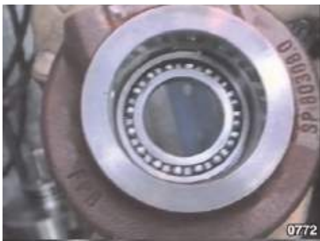
Fig. 57 - Si nécessaire, déposer le circlip et déposer de la cloche de l'embrayage de la gamme "MEDIUM" le palier.
