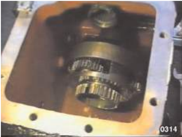
Fig. 19 - Déposer le flasque porte-satellites du réducteur épicycloïdal .
