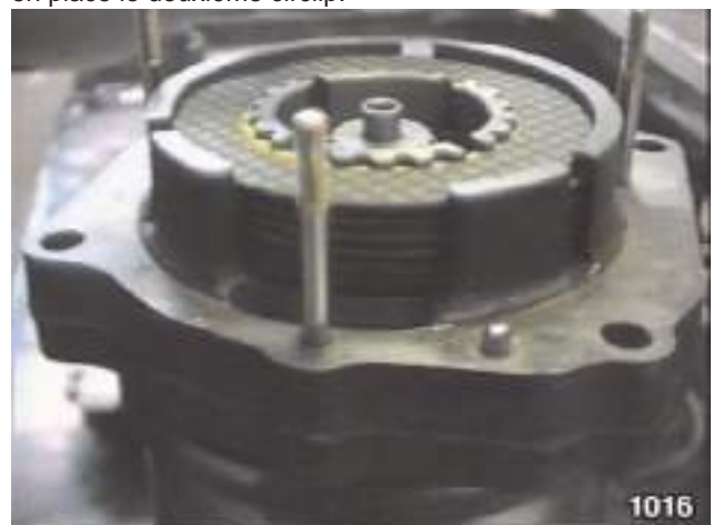
Fig. 83 - L'empilage des disques est complété par le positionnement d'un disque d'embrayage, la denture duquel n'engrène pas avec le moyeu; il convient donc pendant l'opération de positionnement du couvercle de ne pas tourner l'arbre pour permettre l'emboîtement du disque avec le moyeu.
