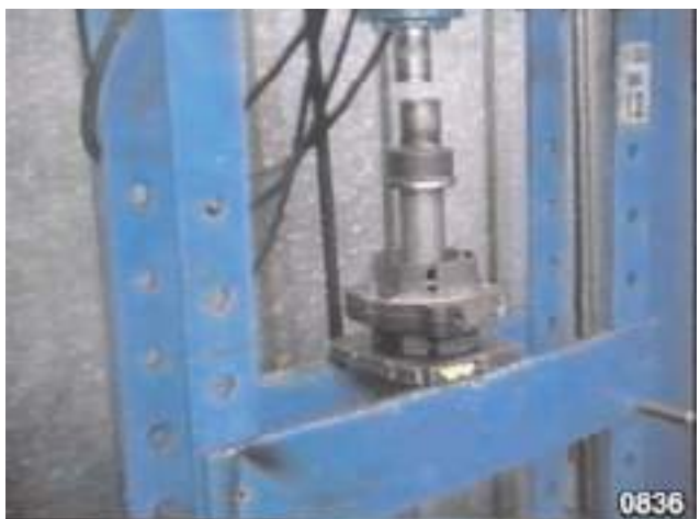
Fig. 60 - Procéder au démontage du piston de l'embrayage de la gamme "LOW" à l'aide d'une presse.
