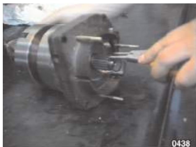
Fig. 33 - Déposer le circlip placé derrière le moyeu de l'embrayage de la gamme LOW.
