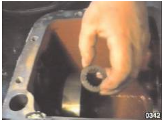
Fig. 20 - Déposer le circlip et la rondelle d'appui. La rondelle d'appui doit être remontée en orientant les fraisages de lubrification tournés ver l'avant du tracteur, à savoir vers le flasque porte-satellites.
