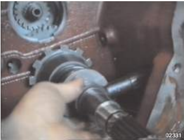
Fig. 56 - Positionnement de l'arbre pour 4 RM équipé du système d'engagement-dégagement du pont avant. Après la mise en place de l'arbre, raccorder le collecteur de l'huile au moyen du tuyau de forme spéciale avec l'électrovanne de commande placée dans le support côté droit du carter de boîte.
