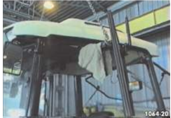
Fig. 16 - Soulèvement de la cabine du tracteur à l'aide d'un palan.
