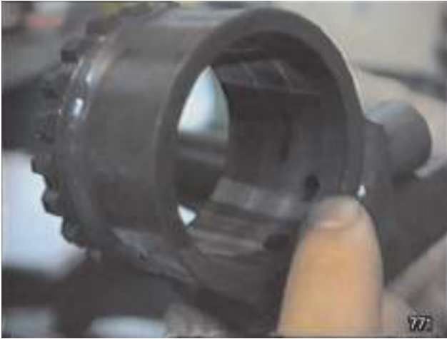
Fig. 37 - Les deux trous en premier plan du collecteur indiqués en figure servent à la lubrification des disques de l'embrayage, tandis que le plus grand trou plus en arrière sert à actionner le piston de commande.
