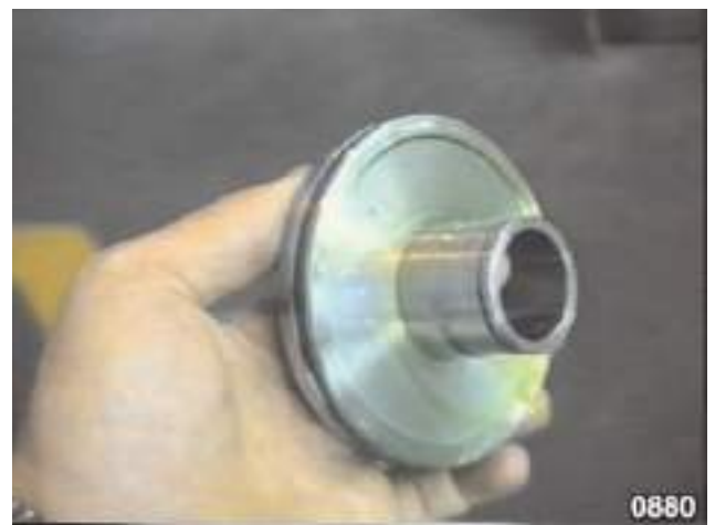
Fig. 66 - Vérifier l'état du joint d'étanchéité du piston de la cloche de l'embrayage de la gamme "LOW".
