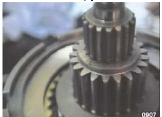
Fig. 77 - Monter la bague de l'embrayage "MEDIUM" avec les dégagements orientés vers le circlip.
