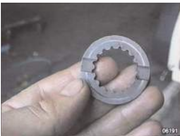
Fig. 60 - Le réglage du jeu s'effectue en choisissant la cale (rondelle) indiquée en figure d'une épaisseur adéquate et en suivant les instructions fournies à la page 35.
