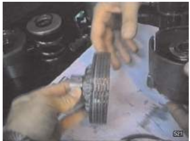
Fig. 24 L'empilage complet des disques peut être déposé en le faisant sortir simultanément à l'extraction du moyeu de l'embrayage.
