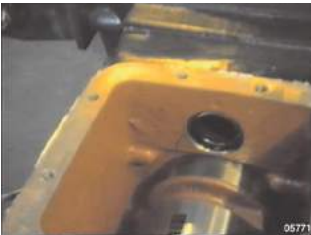
Fig. 66 - Joint d'étanchéité de l'arbre interposé entre l'embrayage et la boîte de vitesses. Ce joint peut être remplacé en accédant par l'intérieur du carter de boîte avant.
