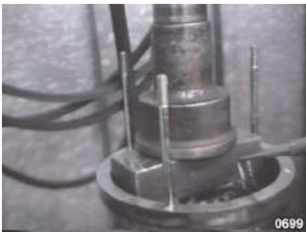
Fig. 51 - Désaccoupler la cloche de l'embrayage HIGH de la cloche de l'embrayage MEDIUM à l'aide d'une presse pour comprimer les ressorts et déposer le circlip.
