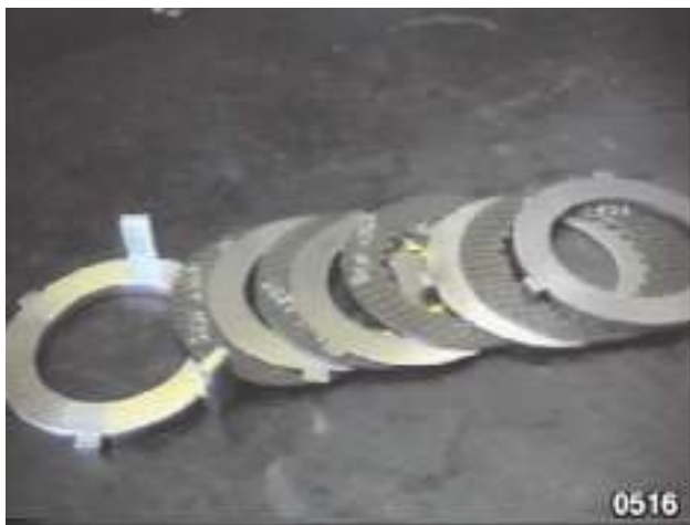
Fig. 39 - Disques de l'embrayage "MEDIUM" (4 disques d'embrayage+3 contre-plaques+2 entretoises).
