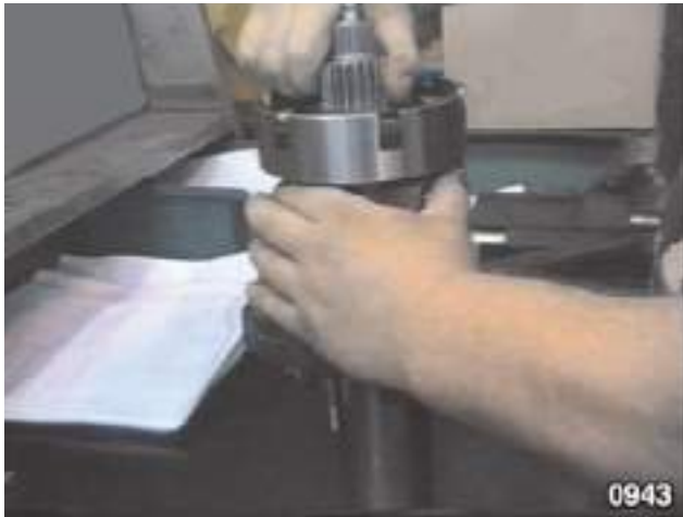
Fig. 78 - Lors de l'accouplement des deux cloches, les goujons (prisonniers) s'engagent dans trois alésages de sorte que les parties doivent nécessairement s'unir correctement. Tourner l'arbre pendant l'accouplement des cloches de manière à centrer les disques de l'embrayage.
