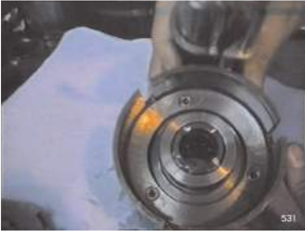
Fig. 25 - Contrôler l'état du piston; on remarque sur la figure les trois pions pour le blocage du frein de l'embrayage à travers la réaction du ressort hélicoïdal quand la pression hydraulique d'enclenchement vient à manquer.
