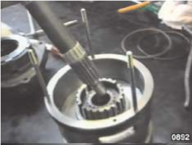
Fig. 72 - Assembler l'embrayage "HIGH". Monter le roulement muni de ses joncs dans la cloche de l'embrayage "MEDIUM", monter le moyeu en le fixant avec son circlip et placer les 3 circlips de service dans la cloche. Monter le piston après avoir mis en place les joints toriques sur celui-ci.
