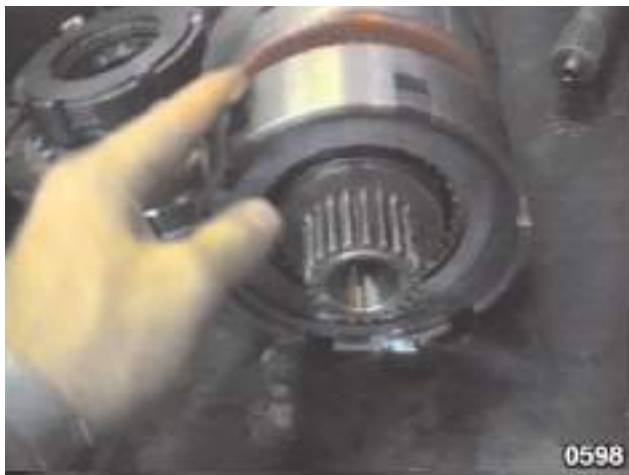
Fig. 45 - Ce piston peut être dégagé en déposant le circlip d'arrêt des ressorts de rappel du piston placé du côté opposé à la cloche.
