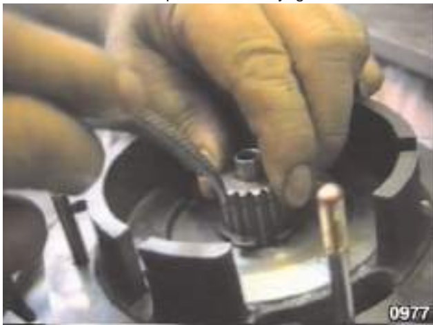
Fig. 80 - Monter l'embrayage des vitesses "LOW" en plaçant d'abord le circlip sur l'arbre comme le montre la figure.
