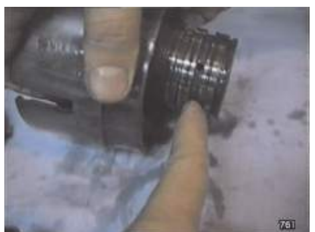
Fig. 36 - Déposer les segments et en contrôler l'état d'usure.
