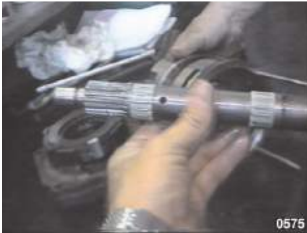
Fig. 43 - Contrôler que les trous de lubrification percés sur l'arbre ne sont pas obstrués.
