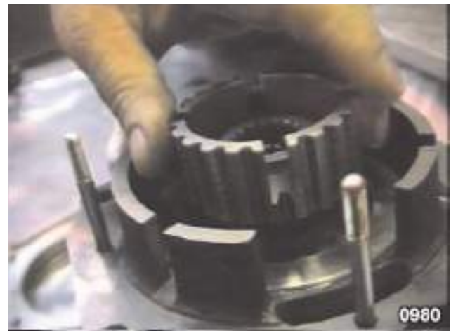
Fig. 81 - Monter ensuite le moyeu de l'embrayage et mettre en place le deuxième circlip.
