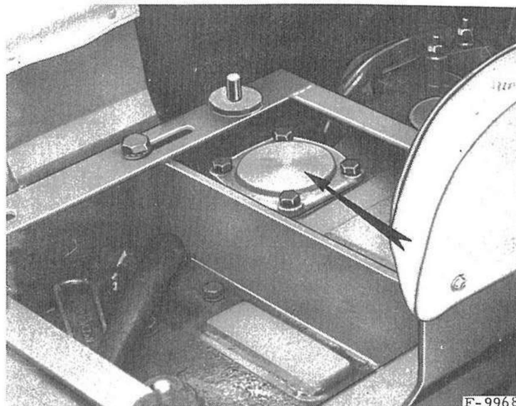
Fig. 24.- Filtre de l'hydraulique
