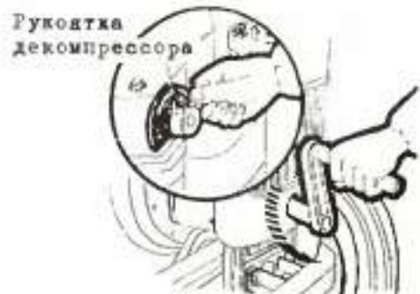
Рис. 2-2 Схема положения "декомпрессия"
