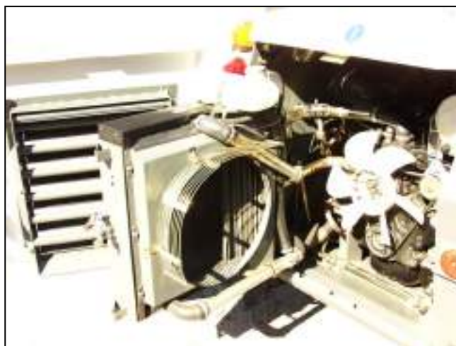
Рис. 11- Откинутый комбинированный радиатор
