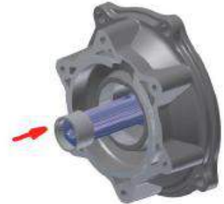
4 inserire il distanziale Introduce the spacer
