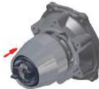
7 montare la nuova frizione Fit the new clutch
