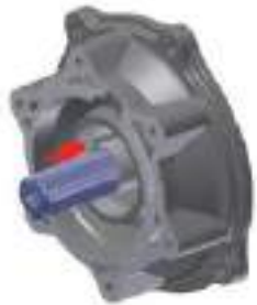
5 mandare in battuta il distanziale Put in position the spacer
