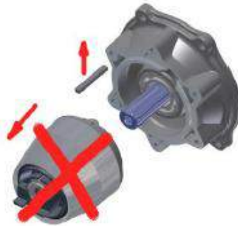
2 togliere la frizione e la chiavetta Take out the old clutch and the key
